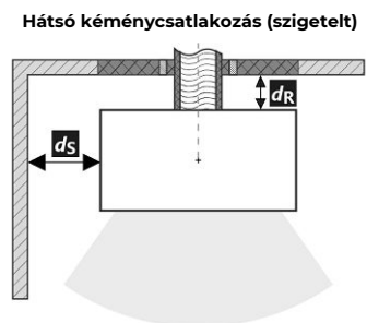
A füstcső áthaladása éghető anyagból készült falon
