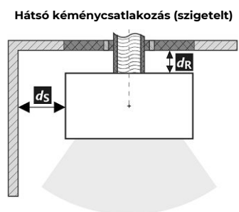
A füstcső áthaladása éghető anyagból készült falon
