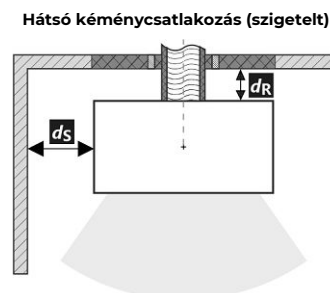
A füstcső áthaladása éghető anyagból készült falon
