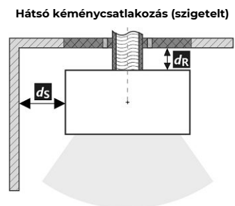
A füstcső áthaladása éghető anyagból készült falon
