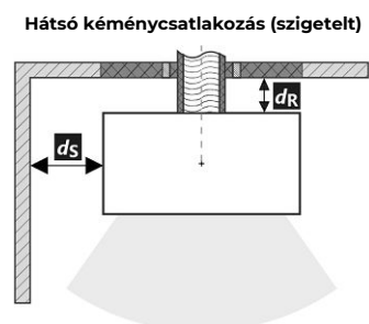
A füstcső áthaladása éghető anyagból készült falon
