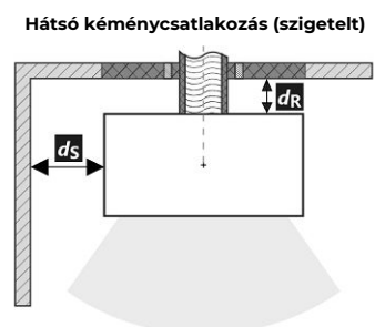
A füstcső áthaladása éghető anyagból készült falon
