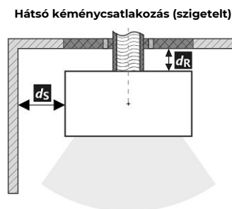
A füstcső áthaladása éghető anyagból készült falon
