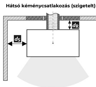
A füstcső áthaladása éghető anyagból készült falon
