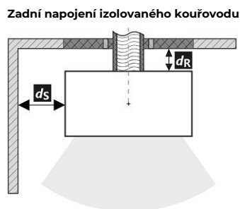
Prostup kouřovodu stěnou z hořlavé hmoty ČSN 06 1008
