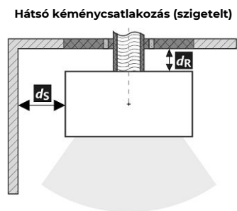
Hátsó kéménycsatlakozás (szigetelt)
