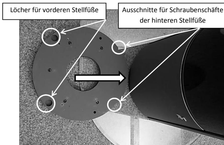
Das Gerät nach hinten neigen und den Drehteller mit dem Fuß gerade unterschieben, bis die beiden Ausschnitte des oberen Drehtellerblechs auf die Schraubenschäfte der hinteren Stellfüße anstoßen. Die vorderen Stellfüße sinken dann in die zwei Löcher (siehe „1“ und „2“) des oberen Drehtellerblechs ein.
