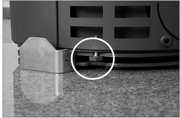
Links in dem Holzfach ist in der Öffnung ein Gewindestift M8x25 sichtbar. Dieser dient als eine Transport-/Montagebefestigung des kompletten Drehtellers. Er muss mit dem Imbusschlüssel 4 herausgedreht und durch die beigelegte Arretierungsschraube ersetzt werden.
