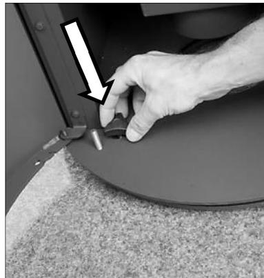
Den beigelegten Handgriff zum Drehen des Gerätes in die zwei Löcher in der rechten Seite des Holzfachs mit zwei Schrauben M5x12 befestigen (Maulschlüssel 8).
